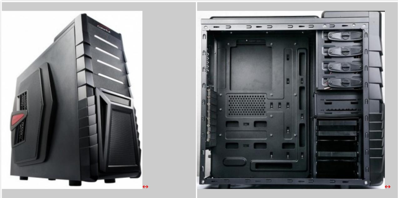
Colorful presenta il↔ Raynor, un case mid-tower che misura 19x58x51 centimetri e pesa 8 kg. La struttura del prodotto è realizzata in acciaio SECC, ma il pannello frontale e gran parte del cabinet sono in plastica.
