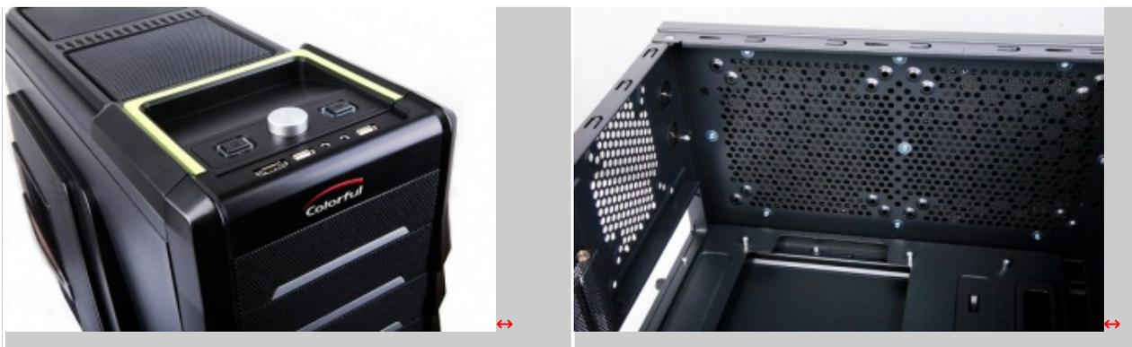
All'interno del Raynor sono presenti quattro alloggiamenti per unità da 5,25 pollici e sette per hard disk da 3,5"; grazie alla buona spaziatura presente tra cestello dei dischi e supporto mainboard è possibile montare anche VGA di grandi dimensioni.
