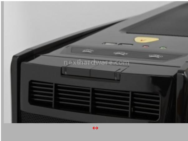
La parte superiore è caratterizzata dalla presenza di una griglia metallica, scopriremo in seguito la sua funzione. La parte anteriore reca il logo PGS, due porte USB aggiuntive e due connettori audio/microfono. Sul frontale troviamo i pulsanti di accensione e reset ed una griglia di sfogo dell'aria calda. Sono presenti anche 3 pulsanti che sono le regolazioni del rheobus integrato.
