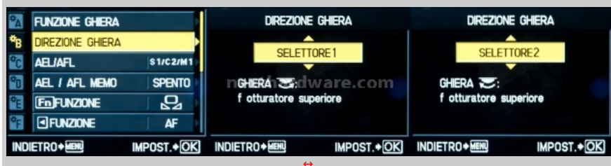
La ghiera dell'immagine in alto a dx può essere a sua volta personalizzata anche nel senso della rotazione: da dx verso sx e viceversa, a seconda di come l'utente si trova più comodo.
