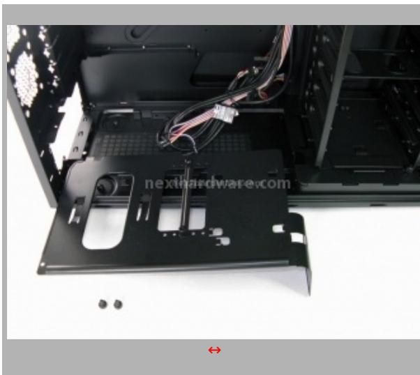
Il vano centrale divide la zona dell'alimentatore dalla sezione della scheda madre ed è dotato di feritoie per il passaggio dei cavi inoltre può anche essere rimosso, per una più semplice collocazione degli elementi in fase di montaggio.
