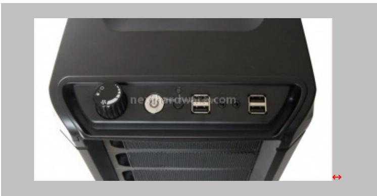
Le tre ventole da 200mm dell'Element G si distinguono anche per la possibilità di poter cambiare il loro colore. Tramite la pressione della manopola di comando, posta nella parte superiore del Case, in pochi istanti è possibile passare dal colore blu, al rosso, al verde e multicolore.
