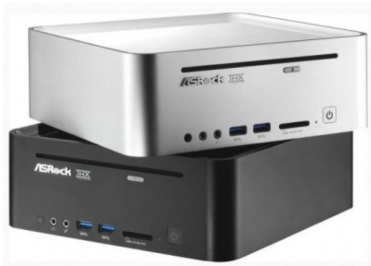
ASRock ha annunciato recentemente il mini PC Vision 3D 135B, un sistema molto compatto che misura 200x70x200 mm basato sulla piattaforma Calpella mobile di Intel, con funzionalità DirectX 11 supporto 3D Vision.
