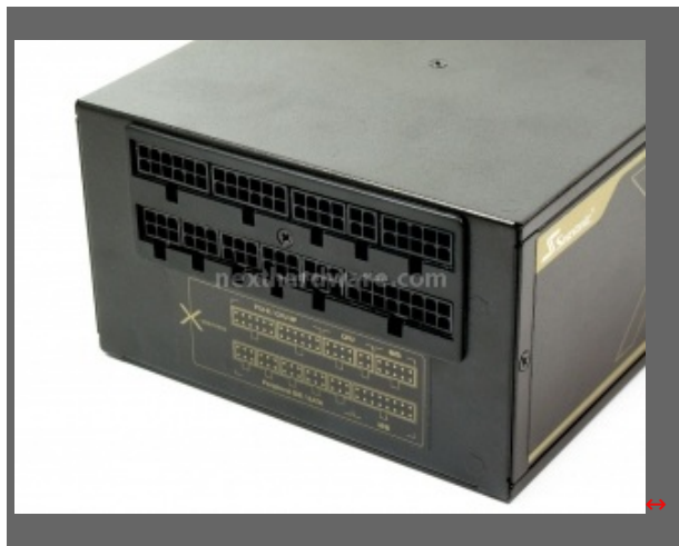
La parte più caratteristica di questo alimentatore è ben visibile in questa foto, sono presenti infatti alloggiamenti per ben 11 connessioni modulari. Un occhio esperto si domanderà come mai il cablaggio per il connettore ATX 24 pin sia suddiviso in due sezioni distinte. Esaminando la struttura interna sveleremo il "segreto".
