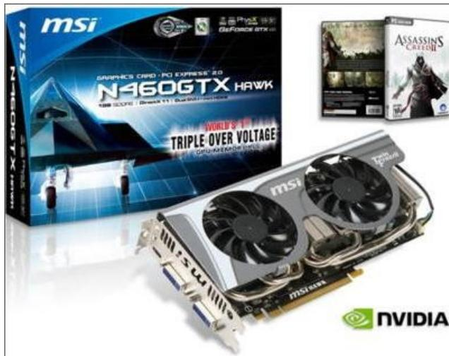
MSI rilascia per la vendita, la versione Hawk della scheda GeForce GTX 460 che dispone di un dissipatore Twin FrozR II costituito da un quattro heatpipes collegate ad un corpo dissipante raffreddato da due ventole da 80 millimetri.
