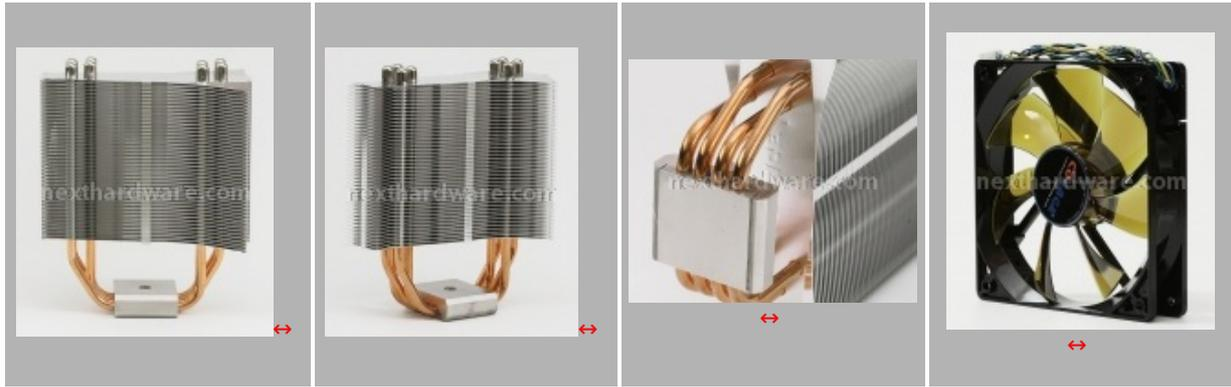
Forma asimmetrica per quanto riguarda il profilo delle 48 alette in alluminio. Il design delle stesse, proprietario, consente di ridurre la resistenza del flusso d'aria. Il peso si attesta sui 670gr. La base è in rame nickelato, le heat pipes sono saldate nel "sandwich" per permettere il massimo scambio di calore. La ventola da 12cm è prodotta da Cogage stessa, trovate le caratteristiche nella prima pagina di questa review.
