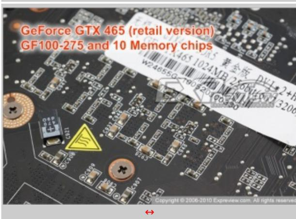
Come potete notare dalla sequenza di foto in alto, la GTX 465 di destra è dotata della stessa GPU che equipaggia la GTX 470 e di un numero di chip di memoria pari a 10 anziché i canonici 8. Se siete i fortunati possessori di una VGA di questo tipo potrete tranquillamente trasformarla in una GTX 470, con due procedure diverse.
