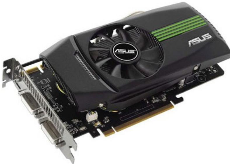
Contemporaneamente al lancio della GTX 460, Asus ha presentato oltre alle normali versioni reference, due versioni Overclocked, dotate di sistema di dissipazione DirectCu.
