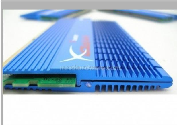
Il tipico sistema di dissipazione della serie HyperX in alluminio color azzurro di pregevole fattura e molto gradevole alla vista.
