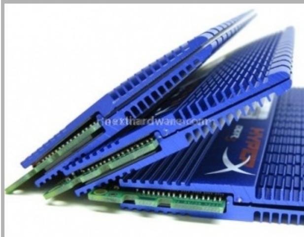
A dispetto delle dimensioni imponenti del dissipatore osserviamo che, come dichiarato dal produttore nel datasheet delle memorie, ciascun modulo dovrebbe produrre 1,8 watt di calore da dissipare, in condizioni di funzionamento standard.
