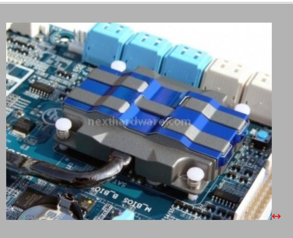
Il chipset è posizionato nella zona inferiore della scheda madre in prossimità degli slot PCI. Gigabyte è stata dunque costretta a ridurre l'altezza complessiva di questo dissipatore in modo da non intralciare l'installazione delle schede video più ingombranti. A differenza del blocco centrale, fissato alla scheda madre con viti, questo dissipatore usa i classici pushpin di plastica.
