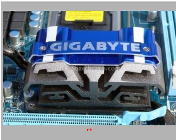
Il nodo centrale del sistema di raffreddamento è questo blocco di alluminio lavorato e satinato per offrire un notevole impatto estetico, la sua funzionalità è quella di collegare le heatpipe dei dissipatori dei mosfet a quello del Chipset, in modo da garantire una miglior distribuzione del calore su tutta la scheda madre.
