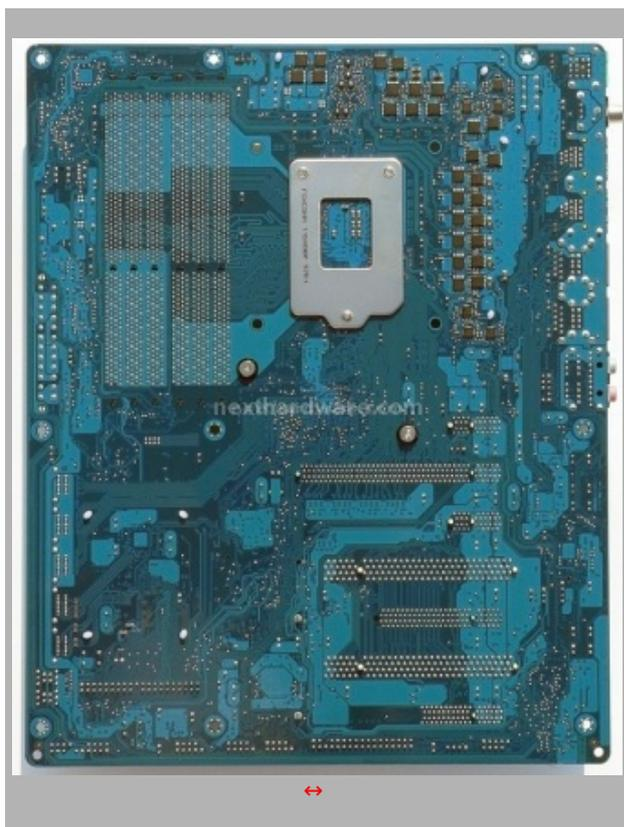
Data la complessità del circuito di alimentazione, Gigabyte è stata costretta ad installare alcuni componenti di "potenza" anche nel retro della scheda madre.
