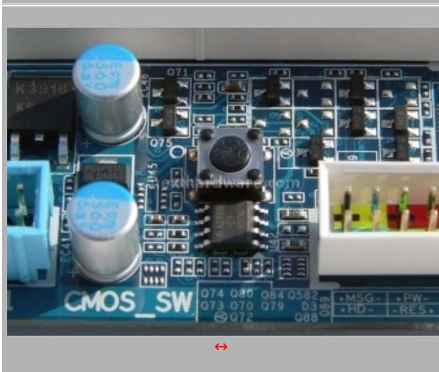
La scheda è nata anche per utilizzo da "banco" integrando un comodo pulsante di accensione (a lato delle memorie), un pulsante per il reset del BIOS e infine un'uno per il riavvio forzato del sistema, posizionato a lato del dissipatore del chipset (posizione piuttosto infelice a nostro avviso).
