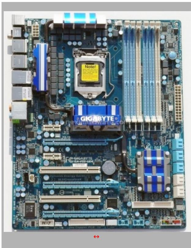
Il formato scelto non poteva essere che il Full ATX, ogni centimetro quadrato è stipato di componenti. A differenza delle altre schede madri P55, la UD6 è dotata di 6 slot di memoria DDR3, questa caratteristica non estende a 3 canali il bus di memoria dei processori 1156, ma rende possibile l'installazione di quantità di memoria più elevate senza l'utilizzo di costosi moduli da 4 GB. Per sfruttare tutti e 6 gli slot è necessario seguire le configurazioni consigliate sul manuale d'uso.
