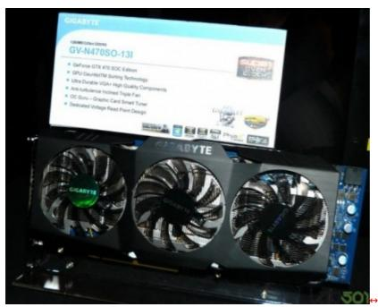
Vista un paio di giorni fa a nudo, senza il dispositivo di raffreddamento, la Gigabyte GeForce GTX 470 Super Overclock è stata mostrata al Computex, nella sua veste definitiva che prevede un raffreddamento triple-fan che dovrebbe tenere il GF100 a temperature accettabili.
