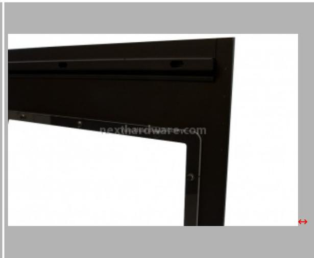
Pregevole la fattura dei pannelli laterali di Obsidian 800D, nelle immagini vi mostriamo quello dotato di finestra in plexy, fissata allo stesso con viti e dadi di ridotte dimensioni.
