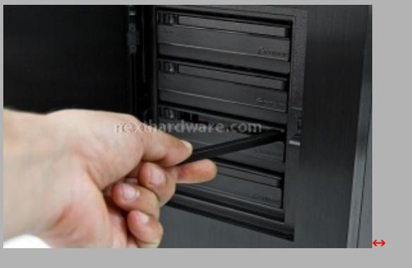
Unica nel suo genere la soluzione scelta da **Corsair** per la gestione degli HD, ben 4 "cestelli" con funzionalità **hot swap** sono celati da un pannello frontale apribile a pressione. Una volta predisposte le connessioni alla scheda madre, la sostituzione/aggiunta di hard drive alla nostra macchina può essere effettuata agendo comodamente dall'esterno, senza alcun bisogno di aprire il case. Le immagini alla destra illustrano i passaggi necessari alla rimozione dei cestelli.
