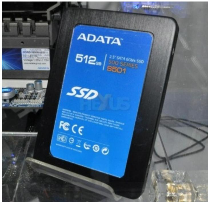
A-data ha presentato al Computex il nuovo SSD S501 con fattore di forma da 2,5" ed interfaccia SATA 6GB/s, che al pari del Micron Real SSD utilizza il controller Marvell.
