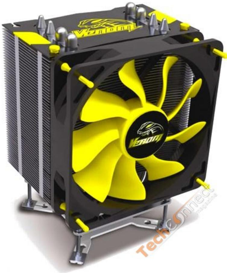
Il Venom dispone di quattro heatpipes da 8 millimetri in rame nichelato con contatto diretto sulla CPU, 45 alette in alluminio di alta qualità, una cover nera per un look più sexy e una ventola da 120 mm Viper dotata di cuscinetto idro dinamico, pale S-Flow, velocità di 600/1900 RPM ed una rumorosità che varia da 6,9 e 28,9 dBA.
