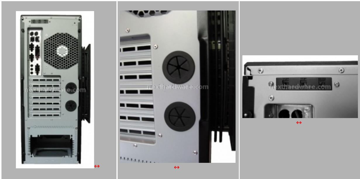
Intravediamo la predisposizione per l'alimentatore in formato proprietario CPX d'Antec. Il nuovo formato aumenta le dimensioni d'ingombro dell'alimentatore, per meglio disporre gli elementi al suo interno, migliorandone così la dissipazione e il funzionamento.
