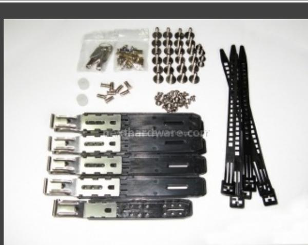
Chiudono l'assortimento, la suite completa delle viti, fascette, clip sgancio rapido, e colonnette di fissaggio per la mainboard.
