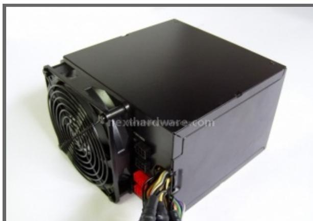
Come possiamo osservare, la ventola di raffreddamento è collocata all'esterno. Notiamo, inoltre, la disposizione delle quattro connessioni modulari.
