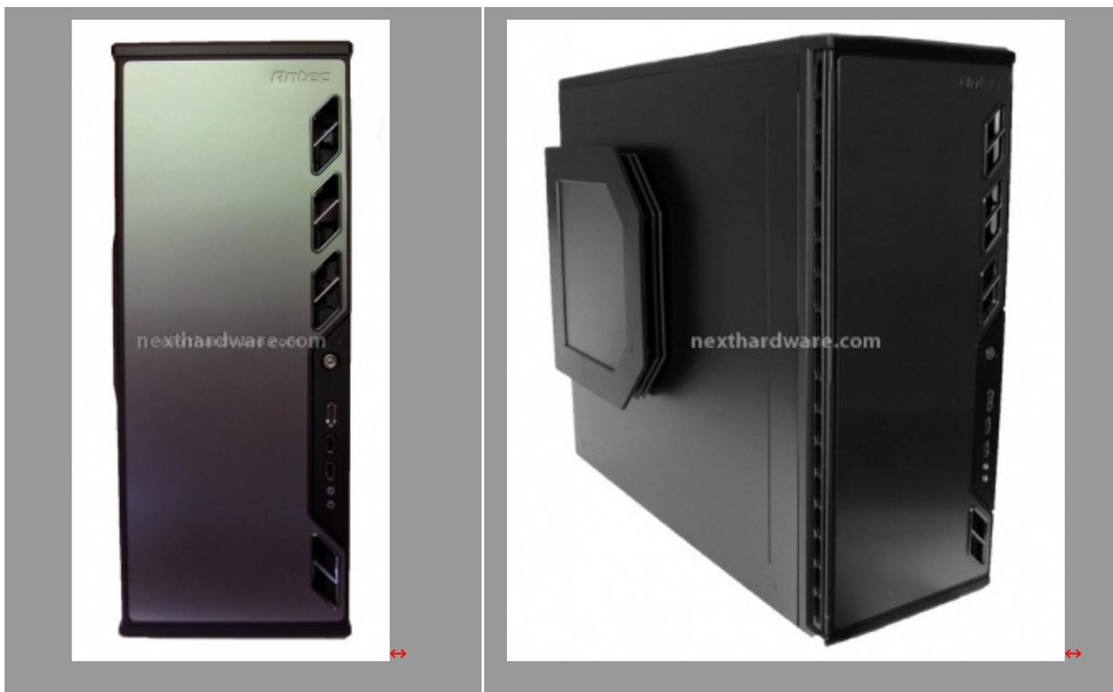
**L'Antec P193** : nel dettaglio il pannello di chiusura anteriore, composto in polimero plastico e rifinito in alluminio brunito, lateralmente si può intravedere la ventola laterale da 200 mm, che immette aria nella zona centrale del telaio.
