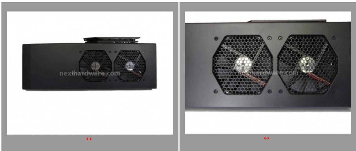
Il lato superiore del P193, sono presenti due ventole regolabili, a tre velocità , da 140 mm.
