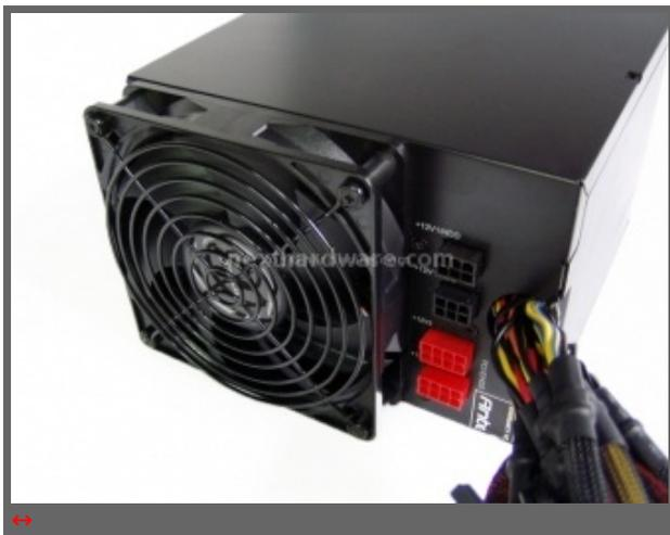
Pannello dei connettori modulari: notiamo la grande massa di cavi saldati, sufficienti per alimentare la maggior parte dei computer in circolazione. Peccato che Antec abbia scelto di non rivestire i cavi fino all'interno dell'alimentatore, probabilmente perché non sarebbe stato possibile contenere l'intero cablaggio.
