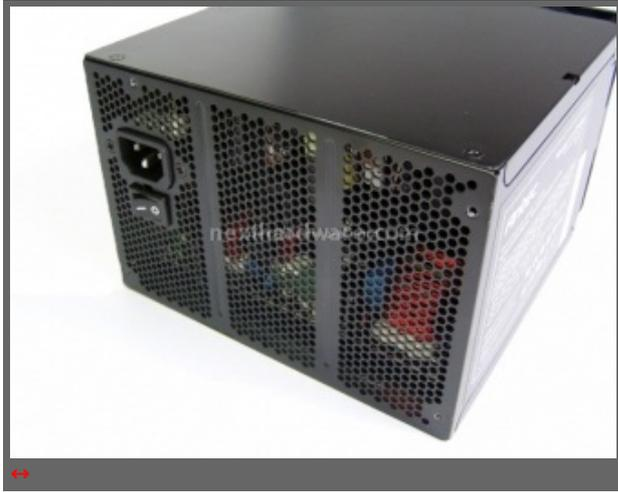
Il lato posteriore lascia intravedere la prima differenza dell'alimentatore CPX. La maggior altezza permette di ridisegnare la disposizione delle componenti al suo interno. La maggior cubatura permette di migliorare la ventilazione interna, diminuendo così le temperature complessive dell'unità .
