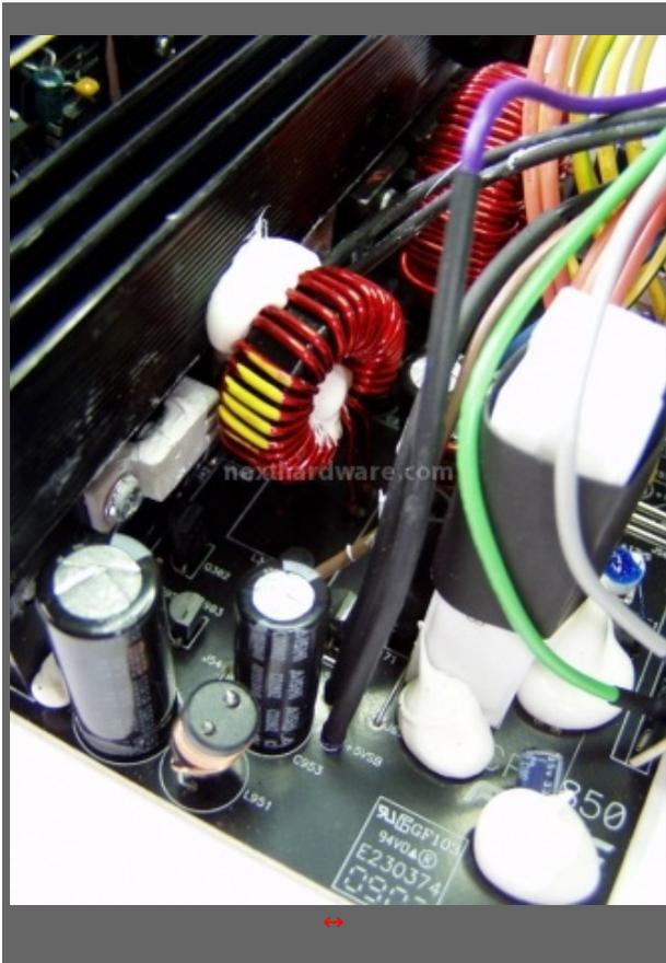
Ecco in dettaglio la linea secondaria composta di tre STPS30L45CT in parallelo per il rail della +5V e 3,3V. Impressionante la sezione di potenza della linea del +12V, ben cinque S60SC6M collegati in parallelo in grado di gestire ben 300A di picco. Quest'approccio ci ha letteralmente sorpreso, mai ci saremo aspettati una simile riserva di potenza in un alimentatore di complemento, il CP850 può competere alla grande con alimentatori più blasonati sotto questo punto di vista.
