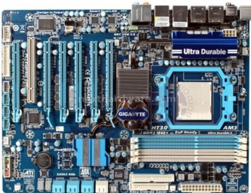
Gigabyte sta preparando il lancio della GA-890FXA UD7, una scheda madre ideale per i futuri sistemi Thuban-powered. Come potete vedere dalle foto, la prossima UD7 è basata sull'accoppiata AMD 890FX + SB850, ha un PCB 20Z di colore blu, un design UltraDurable 3, e vanta un efficiente sistema di dissipazione che include un waterblock rimovibile per il northbridge e un dissipatore Silent-Pipe passivo anch'esso rimovibile.
