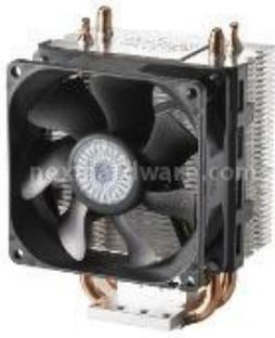
Hyper 101 è un dissipatore dal design universale e dalle dimensioni compatte, compatibile con Socket Intel (LGA 1156/LGA775) e AMD (AM3/AM2/940/939), a ventola singola (seconda ventola opzionale) e con uno spazio ottimale tra le alette, in grado di garantire prestazioni di raffreddamento superiori. ↔
