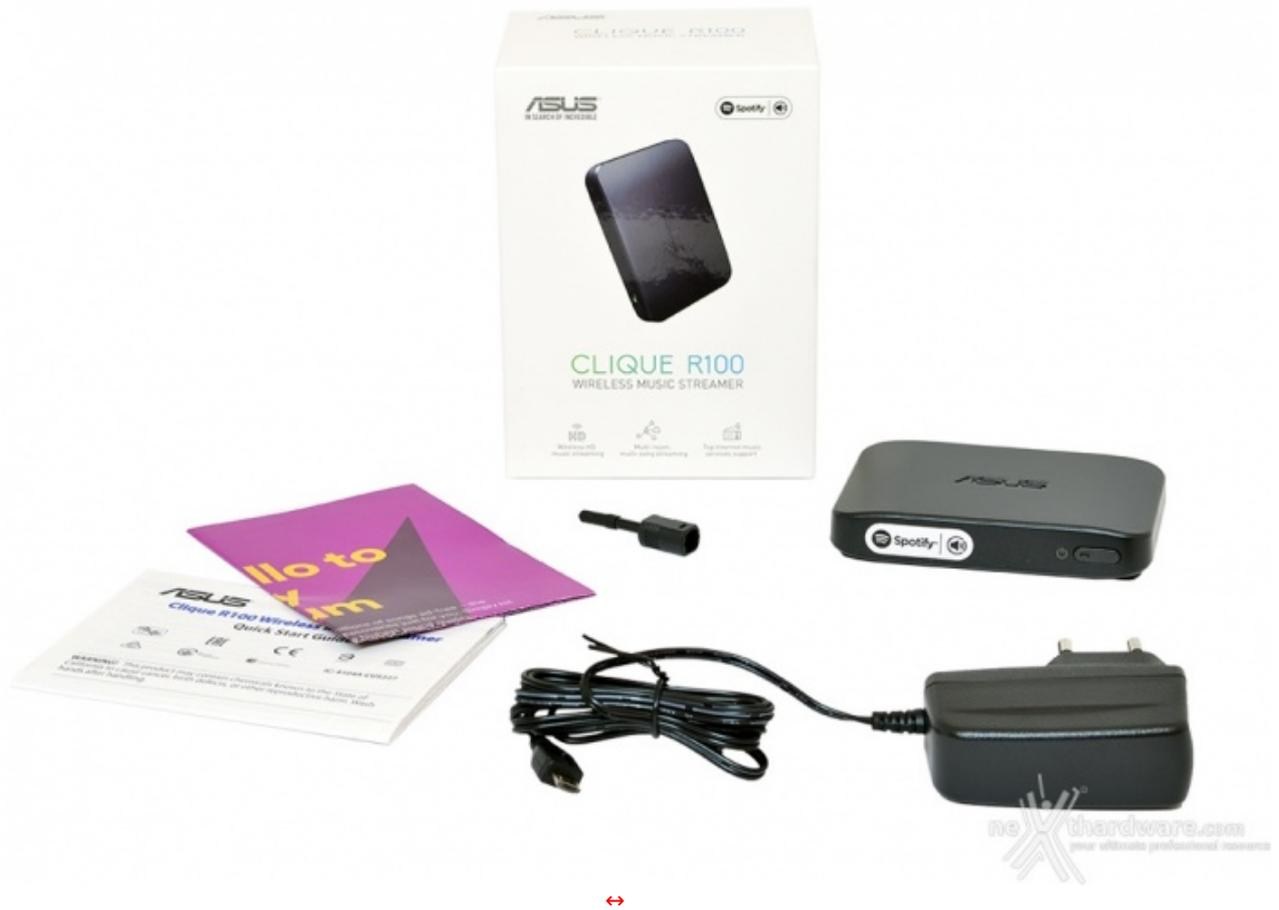
In bundle è presente l'alimentatore da parete con connettore Micro-USB (5V/1A), l'adattatore jack da 3.5mm -> S/PDIF, il manuale d'uso multilingua ed una brochure di Spotify che invita all'utilizzo delle funzionalità Premium (supporto ai dispositivi Allplay, cambio tracce illimitato ed assenza della pubblicità ).
