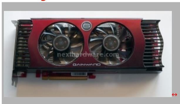
Le dimensioni complessive non si discostano da quelle della GTX 260 reference, ma l'adozione di un dissipatore custom ha permesso l'integrazione di 2 ventole 80x80 mm.
