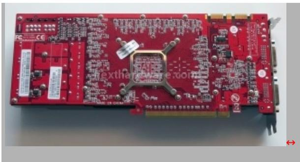
A differenza delle prime GTX260, le versioni a 55nm perdono la placca di protezione posteriore, lasciando visibile il retro del PCB. Gainward ha apposto un sigillo di garanzia sulla staffa del dissipatore, questo impedisce di sostituire lo stesso con un sistema di raffreddamento after market, data la qualità di quello standard però, non riteniamo che questo sia un limite per la maggior parte degli utenti.
