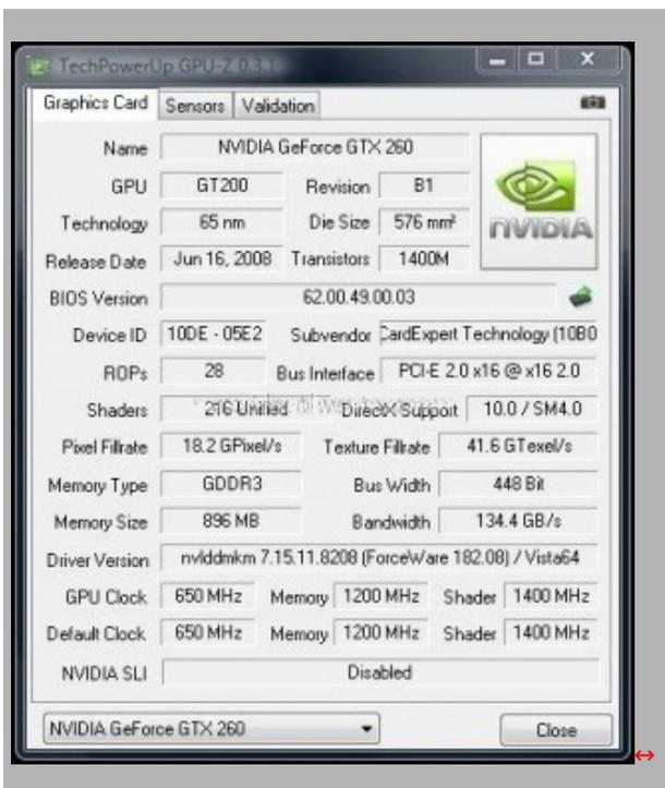
Oltre al dissipatore non standard, la principale differenza che caratterizza la GTX 260 GLH, sono le frequenze di funzionamento.
