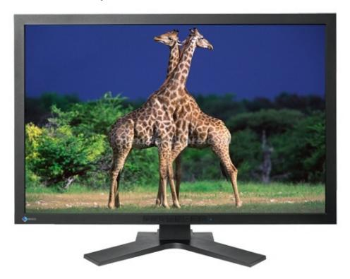
EIZO ha rivelato questa settimana, il suo nuovo monitor da 30 pollici ColorEdge CG303W, un monitor LCD in grado di coprire il 98% della gamma colori di Adobe RGB. Il display dispone di un pannello IPS, una risoluzione nativa di  $2560 \times 1600$  pixel, un tempo di risposta di 12ms, un rapporto di contrasto 850:1 e una luminosità massima di 260 cd/m2.
