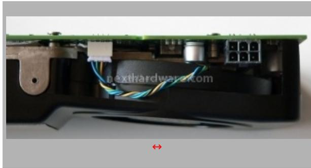
Una delle principali differenze rispetto alla 9800GTX+ è la presenza di un singolo connettore di alimentazione PCI-E 6 Pin. La scheda è accreditata di un consumo massimo di 150 W, 6 in meno rispetto al passato, ricordiamo che la connessione PCI-E 16x può fornire 75w e che il connettore ausiliario può fornirne altrettanti. In foto è visibile il cavo di alimentazione della ventola, dotato di 4 pin.
