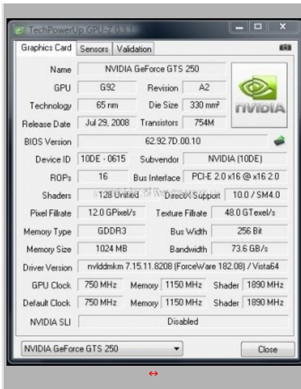
La GPU utilizzata dalla Zotac GTS 250 AMP! Edition è la stessa già vista nella 9800GTX+ e appartiene alla famiglia dei GeForce G92b, costruiti con il processo produttivo a 55 nm.
