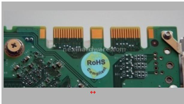
La scheda supporta la tecnologia SLI e 3 Way SLI se utilizzata in abbinamento ad una scheda madre compatibile e ad una o due schede gemelle. NVIDIA ha voluto salvaguardare i suoi utenti rendendo possibile l'utilizzo della tecnologia SLI anche in abbinamento ad una 9800GTX+ dotata dello stesso quantitativo di memoria.
