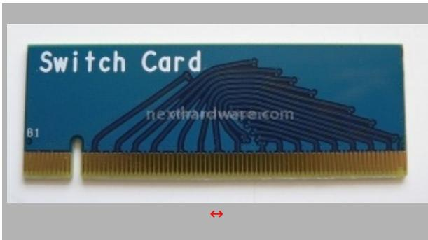
La Switch Card è una tradizione di casa Sapphire ed è necessaria per abilitare piena banda (PCI-E 16x) sul primo connettore della scheda madre. Le schede Sapphire non sono infatti dotate di microswitch per modificare automaticamente il numero di linee PCI-E, questa soluzione ricorda le prime schede madri dotate di chipset Intel 965 ed è stata mantenuta per ridurre i costi e rimuovere una funzionalità che in fin dei conti, porta scarsi benefici all'utente finale.
