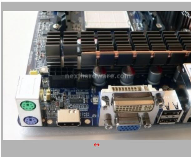
Sul retro del dissipatore mosfet/chipset è presente il connettore di alimentazione 8 PIN, è fondamentale collegarlo affinché la scheda riesca ad operare correttamente. Per chi fosse in possesso di un alimentatore dotato di un solo cavo 4 PIN, dovrà inserirlo in una delle due metà del connettore (il verso è obbligato dalla differente forma dei fori).
