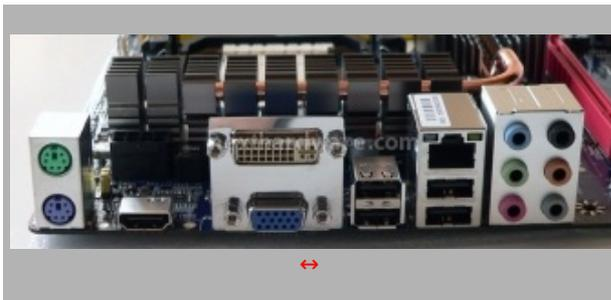
La dotazione di interfacce è completa e comprende: 2 porte PS2 per tastiera e mouse, 1 HDMI con supporto audio multicanale, 1 DVI, 1 VGA, 4 USB 2.0, 1 RJ45 GigaLan, 6 connettori jack per audio analogico Azalia 8 canali. Per abilitare le funzionalità audio della porta HDMI è necessario abilitare l'apposita voce nel BIOS.
