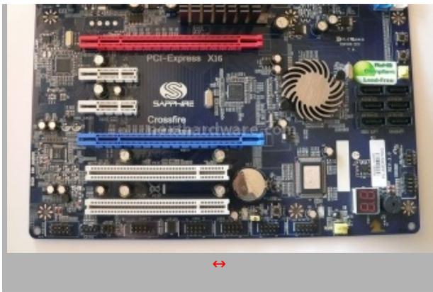
La scheda è dotata di due connettori PCI-E 16x, quello di colore rosso può funzionare in modalità 16x o 8x, il secondo solo in modalità 8x. Sono presenti inoltre 2 slot di espansione PCI-E 1x e 2 PCI 32 bit.
