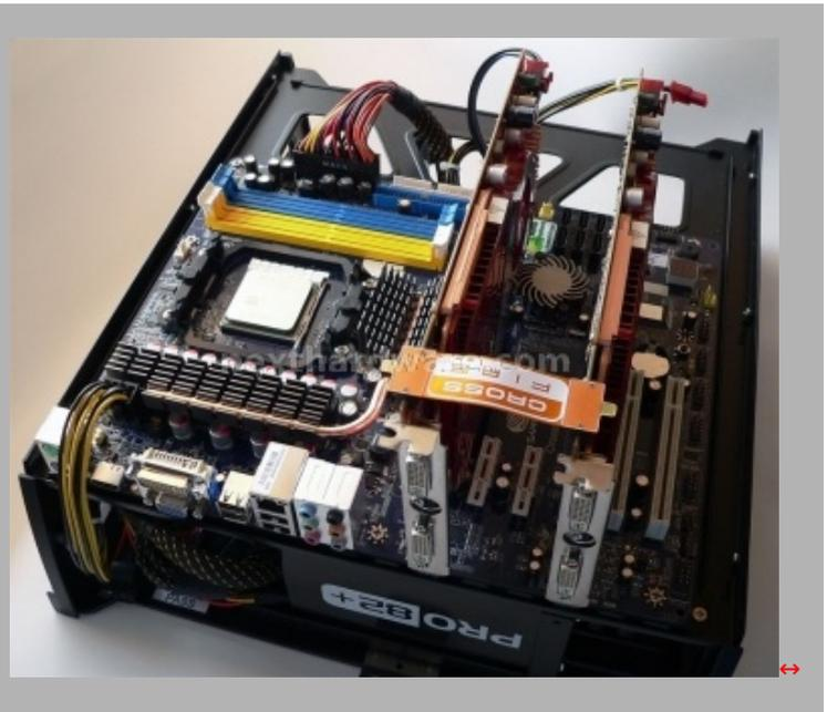
L'installazione di due HD4850 non ha creato problemi, abbiamo installato una scheda per volta e riavviato la macchina quando questa veniva riconosciuta. Il passaggio dal uso della singola scheda video integrata, a due schede video discrete in CrossFireX è avvenuto in maniera completamente indolore, non richiedendo alcun intervento da parte nostra per reinstallare i driver Catalyst.
