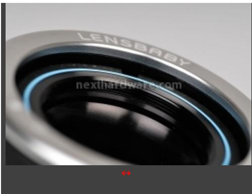
La filettatura con diametro da 37mm, presente su ognuna delle quattro ottiche, consente il montaggio di numerosi accessori previsti da Lensbaby per il suo sistema creativo. E' possibile installare ottiche aggiuntive di conversione per grandangolo (x0,6) e teleobiettivo (x1,6) così come per la macro-fotografia (5cm distanza min. messa a fuoco).
