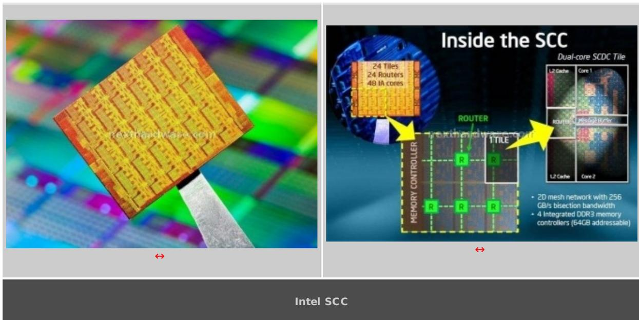
Ecco quindi emergere SCC (Single-chip Cloud Computing), un integrato dotato di 48 unità di elaborazione (24 dual core con 384 KB di cache di secondo livello). Questo prototipo è dotato di 4 memory controller DDR3 in grado di pilotare complessivamente fino a 64 GB di RAM.
