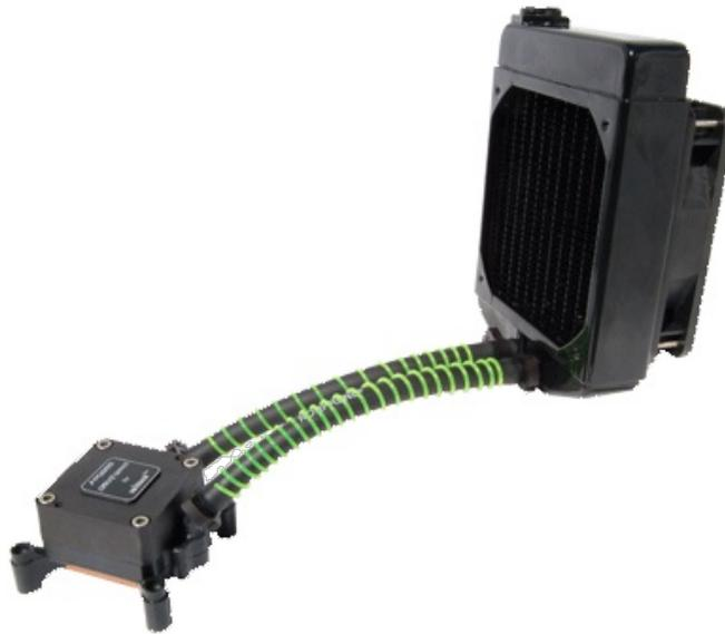
Il primo componente prende il nome di Apogee Drive 350 che lascia intendere da cosa è composto, ovvero il waterblock Apogee e la pompa mcp350 combinati in un unico oggetto. Il secondo componente non è nient'altro che un radiatore monoventola (MCR120) dotato di un tappo per il riempimento del circuito. Questo particolare kit verrà commercializzato sotto il nome di H2O-120 kit.
