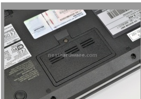
Il piccolo vano destinato alla memoria è protetto da un robusto coperchio in materiale termoplastico bloccato da una vite e tenuto in sede da numerosi dentini di fissaggio disposti su ogni lato.
