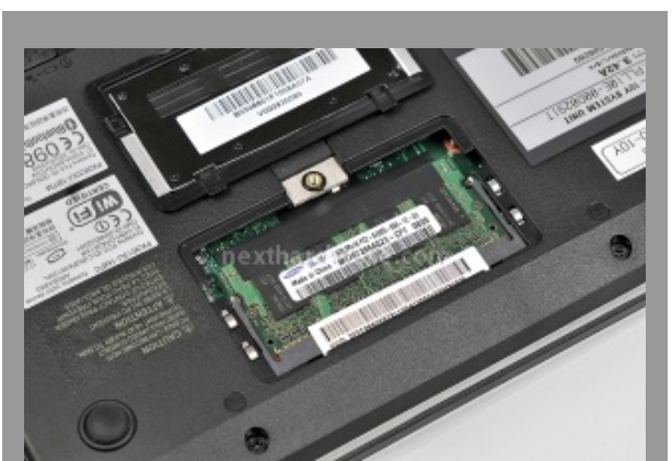
Il modulo da 1GB DDR2 666MHz Samsung installato sul nostro sample.
