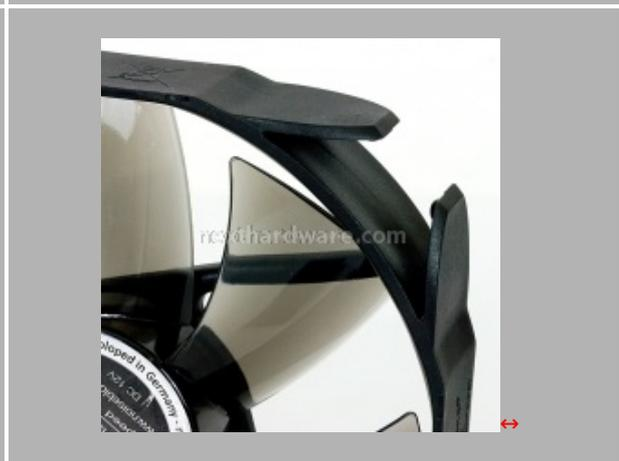
Il gommino, ed il particolare design del telaio della ventola, fanno sì che la stessa, come precedentemente illustrato, non si a contatto con la superficie di montaggio per non trasmetterle alcuna vibrazione. Questa caratteristica, non consente un montaggio delle ventole in oggetto su radiatori per watercooling, in quanto parte del flusso d'aria andrebbe perso vista la costruzione del "frame". Qualora si vogliono utilizzare
