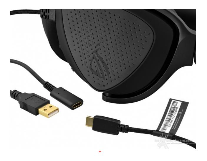
Per l'utilizzo con PC e console prive di connessione di tipo C viene fornito in dotazione un adattatore da USB-C a USB 2.0 che funge anche da cavo prolunga.
