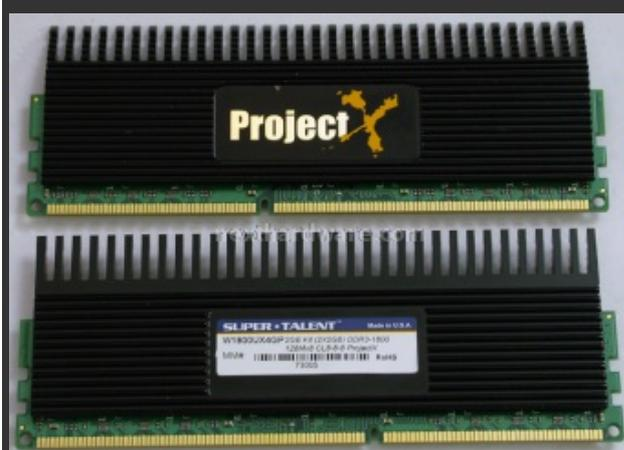
La parte posteriore delle memorie riporta la targhetta con le prestazioni dichiarate dal costruttore: DDR3-1800 MHz con timings 8-8-8-20 e tensione di alimentazione pari a 1,9 volt.
