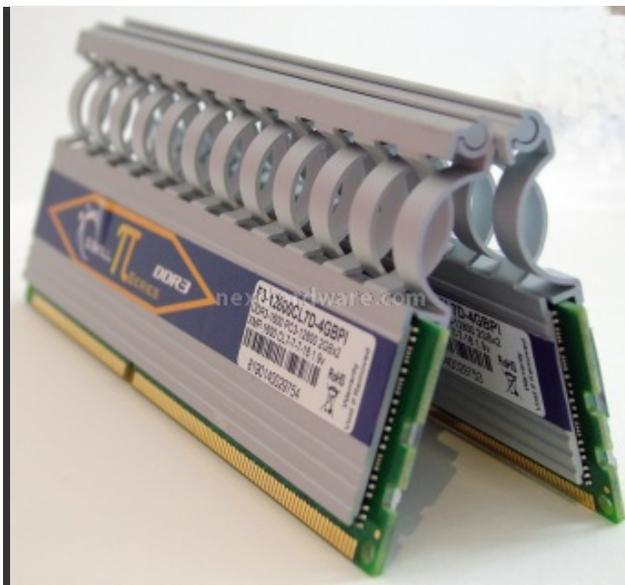
Sul dissipatore non esiste letteratura che riporti particolari capacità di efficienza di dissipazione grazie alla sua particolare forma. Quindi la forma del dissipatore è puro design che, vista l'imponenza dal punto di vista delle dimensioni, potrebbe causare qualche problema di spazio all'interno dei case soprattutto in presenza di dispositivi che tendono a invadere l'area degli slot di memoria. Quindi attenzione all'altezza di questi moduli di RAM.
