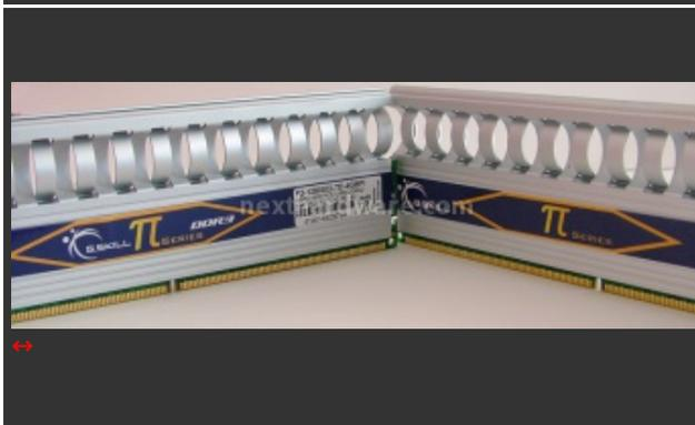
La parte posteriore delle memorie riporta la targhetta con le specifiche dichiarate dal costruttore: DDR3-1600MHz con timings 7-7-18 e tensione di alimentazione pari a 1,9 volt.
