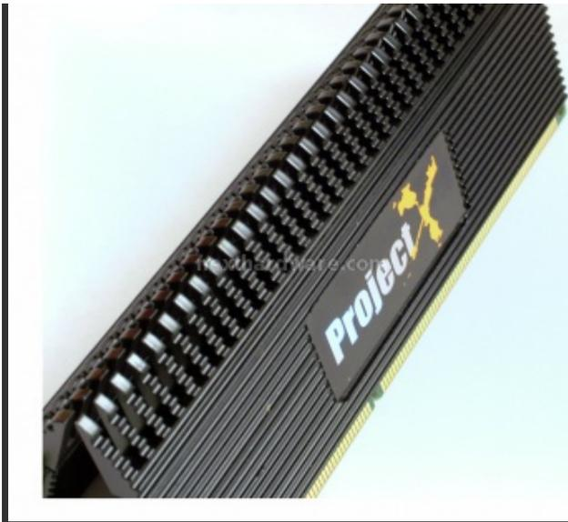
La geometria dei dissipatori con le scanature che percorrono orizzontalmente i moduli e l'effetto leggermente curvato della parte superiore delle alette, oltre a conferire un look molto accattivante ai moduli, dovrebbe consentire una dissipazione ottimale ed efficiente smaltimento del calore prodotto dai moduli durante il loro funzionamento.
