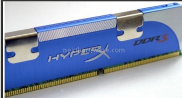
I dissipatori sono tenuti assieme da due clip metalliche che li pressano sugli 8 chip di memorie che sono presenti su entrambe le facce del modulo.
