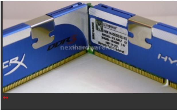
La parte posteriore delle memorie riporta la targhetta con le prestazioni dichiarate dal costruttore: DDR3-1800 MHz con timings 8-8-8-20 e tensione di alimentazione pari a 1,9 volt.
