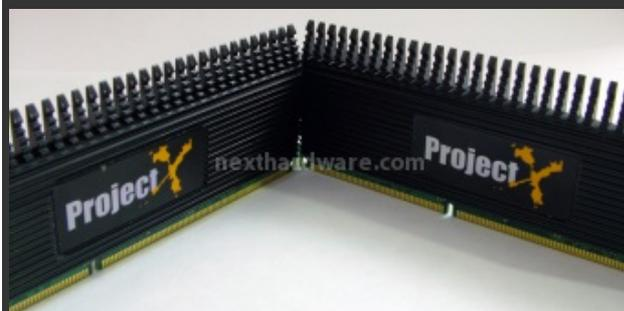
Anche qui siamo in presenza di dissipatori molto imponenti che conferiscono un effetto di solidità alle memorie, ma che necessitano di qualche attenzione nel posizionamento all'interno del case in presenza di altri componenti che tendono a invadere la zona che ospita gli slot di memoria.
