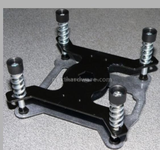
La staffa è dotata di 4 molle autocalibranti, è necessario usare un cacciavite a stella per fissare il waterblock.
