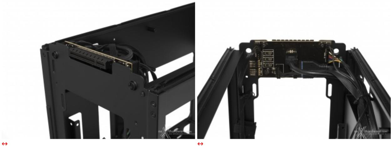
Un dettaglio degno di nota, che speriamo possa trovare spazio anche su altri case, è costituito dal particolare HUB per le connessioni che, frontalmente, prevede un connettore ad incastro per il pannello di I/O mentre, sul retro, i cavi provvisti di apposito connettore su entrambi gli estremi, motivo per cui se la nostra scheda madre, per esempio, non fosse dotata di connettore USB Type-C interno, ci basterà rimuovere il relativo cavo e riporlo in un cassetto.
