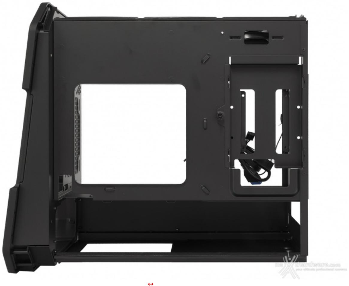
Analizzando il telaio interno dal lato opposto si nota l'ampiezza del vano alimentatore, dove è possibile "stoccare" tutti i cavi in eccesso; anche il retro del piatto mainboard, in teoria, può essere utilizzato per contenere cavi ma, visto il limitato spazio a disposizione, tale opzione risulterà poco pratica.
