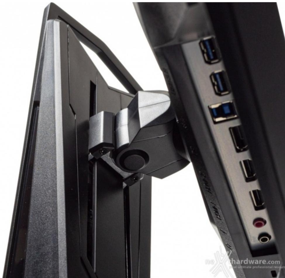
Per la regolazione orizzontale del nostro FI27Q-X, non potendo fare affidamento su una base rotante, è stato collocato uno snodo sul braccio di sostegno.
