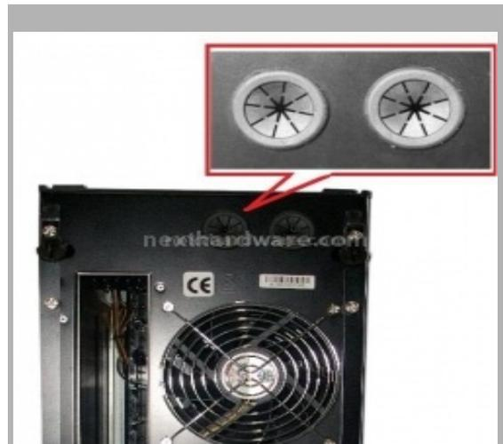
Sul retro sono posti due fori per facilitare l'installazione di un sistema di raffreddamento a liquido
