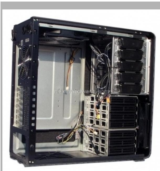
All'interno del case troviamo le due grosse ventole da 18cm che immettono aria all'interno dello stesso e una ventola di espulsione da 12cm e due vani per l'installazione di ben otto hardisk di cui uno con installato il kit di hotswap
