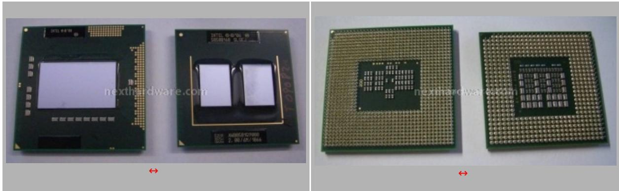
A sinistra è visibile il nuovo Core i7 Mobile, a destra un processore Q9000. Le dimensioni del die sono aumentate, ma ora il design è di tipo monolitico. A differenza della passata architettura il processore ora integra anche il memory controller e gran parte della logica del northbridge, assente nelle soluzioni PM55.
