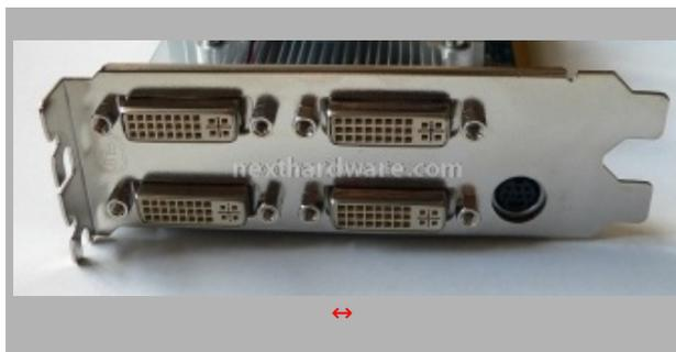
Una delle caratteristiche peculiari della HD4850X2 sono le 4 connessioni DVI presenti sulla doppia staffa PCI. Disabilitando la modalità CrossFireX dai driver Catalyst è infatti possibile gestire in modo indipendente fino a 4 monitor, utilizzando connessioni VGA, DVI, HDMI o Component. Sono supportate contemporaneamente solo due uscite HDMI con audio multicanale (1 per GPU).
