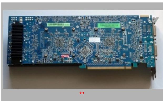
A differenza delle altre schede viste fino ad oggi, la HD4850X2 di Sapphire è dotata di un dissipatore in alluminio anche nella parte posteriore del PCB. Quest'ultimo raffredda parte della generosa sezione di alimentazione ed è necessario per mantenere la stabilità operativa di tutta la scheda. Poco sopra lo slot PCIE 16x 2.0 sono visibili le saldature del bridge PCIE che si occupa di interconnettere le GPU alla scheda madre.
