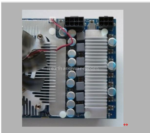
La sezione di alimentazione della Sapphire HD 4850 X2 è molto curata, tutti i dispositivi di potenza sono raffreddati da due appositi dissipatori (uno per lato del PCB), i condensatori sono tutti allo stato solido, al fine di garantire la massima stabilità operativa.
