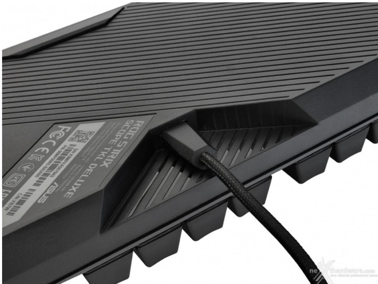
Il collegamento della ASUS ROG Strix Scope TKL al PC è affidato ad un singolo cavo USB removibile, quindi facilmente sostituibile in caso di guasto.
