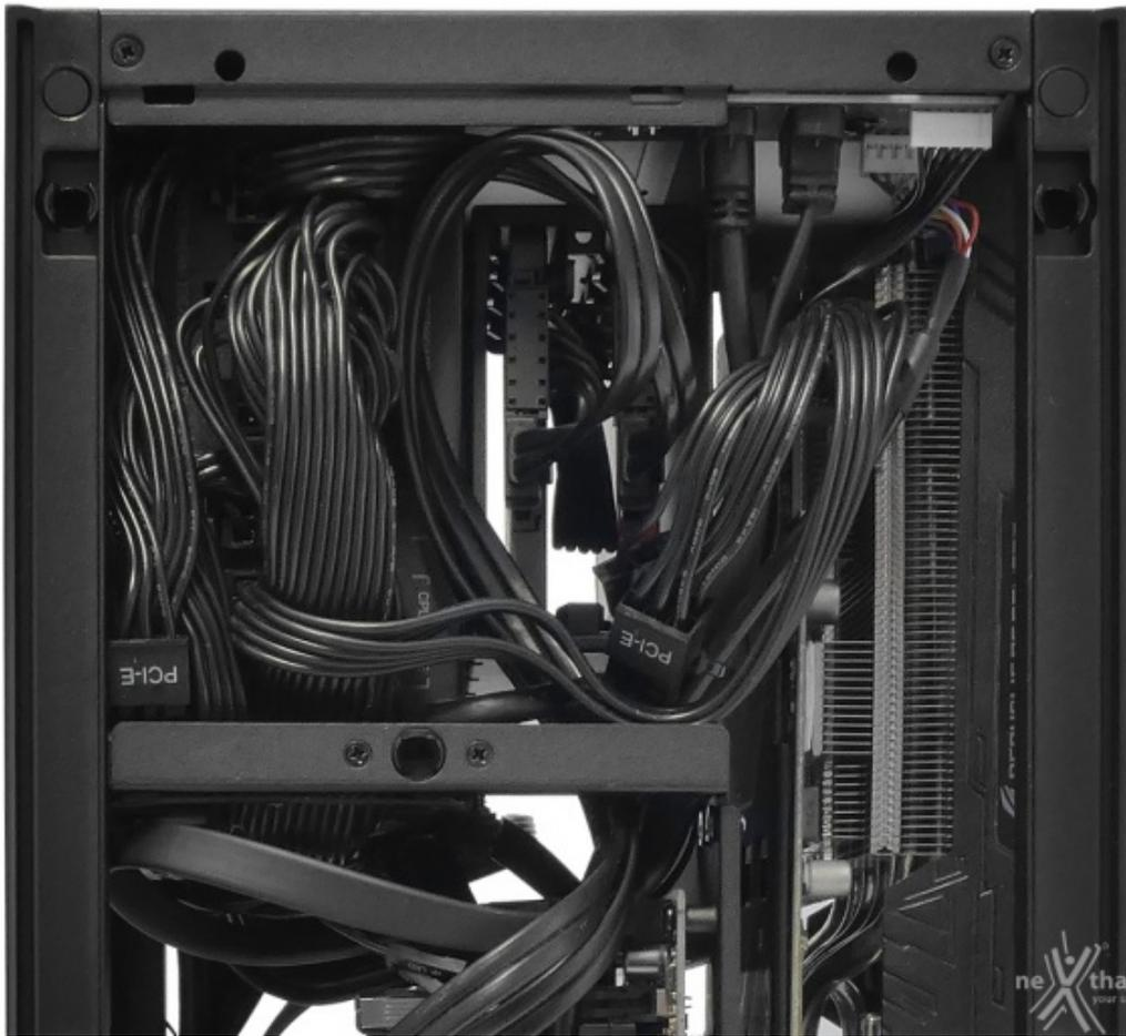
Abbiamo poi inserito due drive all'interno dell'apposito cestello ed effettuato il cablaggio, cercando di andare ad occupare il meno possibile lo scomparto dedicato alla scheda madre.
