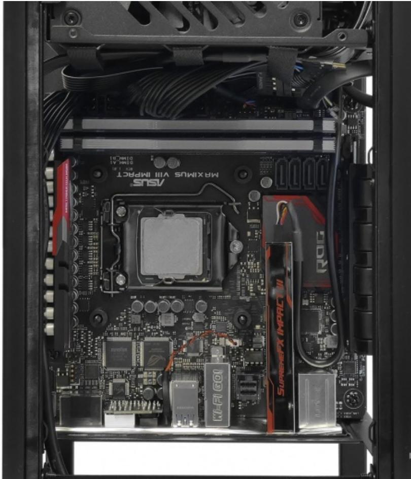
Riprendendo da dove ci eravamo lasciati durante l'analisi dell'interno e, quindi, con lo sportellino che sostiene il sistema di raffreddamento a liquido aperto, abbiamo collocato la scheda madre, completa di sistema di ritenzione per l'AiO, CPU e RAM, sul proprio vassoio, andando ad inserire già alcuni cavi come il 24pin e il Riser Cable PCI.
