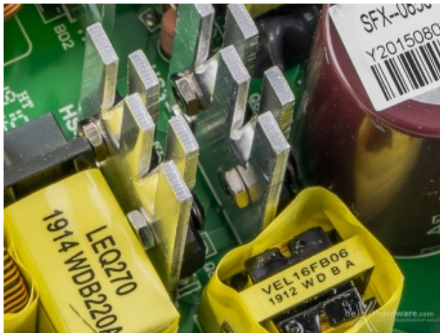
Particolare dello stadio primario di switching.
