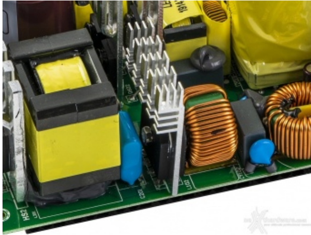
Particolare del doppio ponte raddrizzatore dissipato da un elemento in alluminio dedicato.
