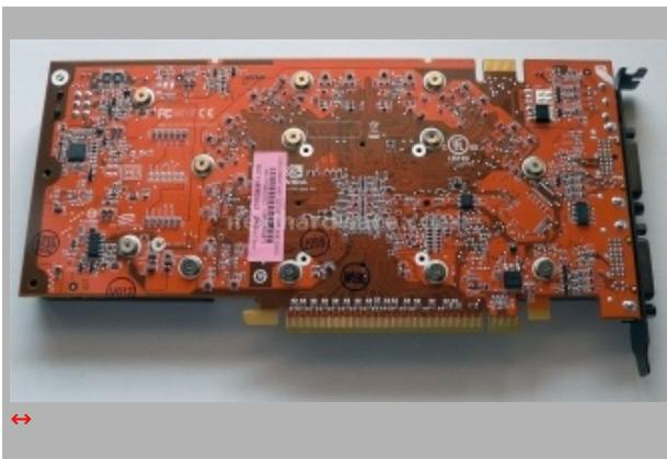
Sul retro non sono presenti componenti discreti significativi, il dissipatore è fissato con numerose viti che rendono molto solido l'assemblaggio.
