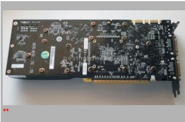
La scheda non è dotata di placca di protezione posteriore come le sorelle maggiori GTX280 e GTX260 ma il PCB è completamente a vista.
