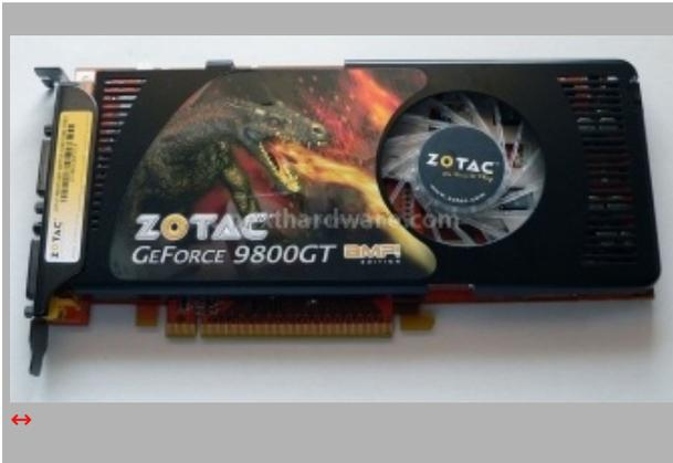
La Zotac 9800 GT AMP! Special Edition è caratterizzata dal pcb di colore arancione, una colore non comune nelle linee di produzione della maggior parte dei produttori, ma che viene realizzato ad hoc per forniture limitate di pezzi. Il dissipatore è simile a quello reference di NVIDIA, ma la ventola trasparente è illuminata da alcuni led arancioni.
