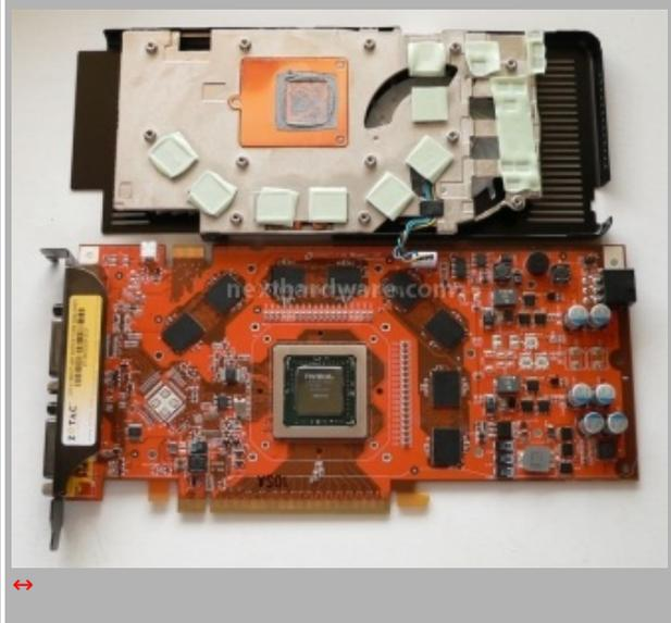
Il design single slot non permette l'espulsione dell'aria calda all'esterno del case ma la convoglia a lato della scheda. Il dissipatore è composto da una base in rame e da una serie di lamelle in alluminio. La ram è suddivisa in 8 moduli disposti a ferro di cavallo attorno alla GPU G92. Zotac ha installato condensatori solidi per garantire tensioni stabili e una miglior efficienza.
