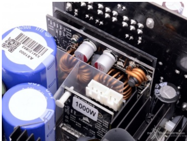
Particolare del modulo DC-DC.
