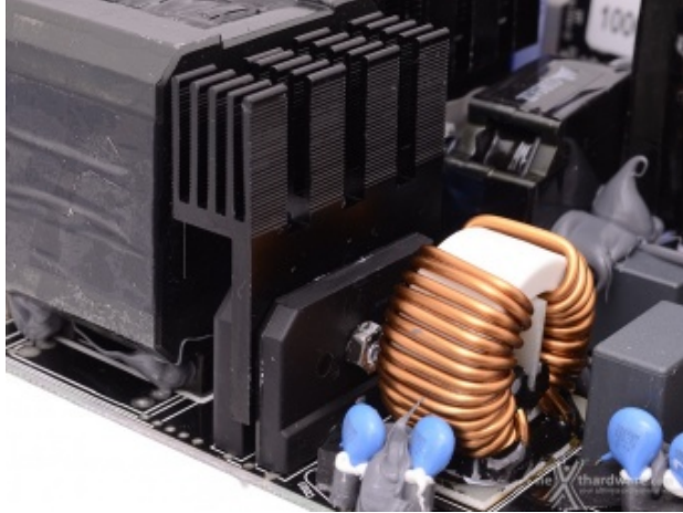
Particolare del doppio ponte raddrizzatore con relativo dissipatore.
