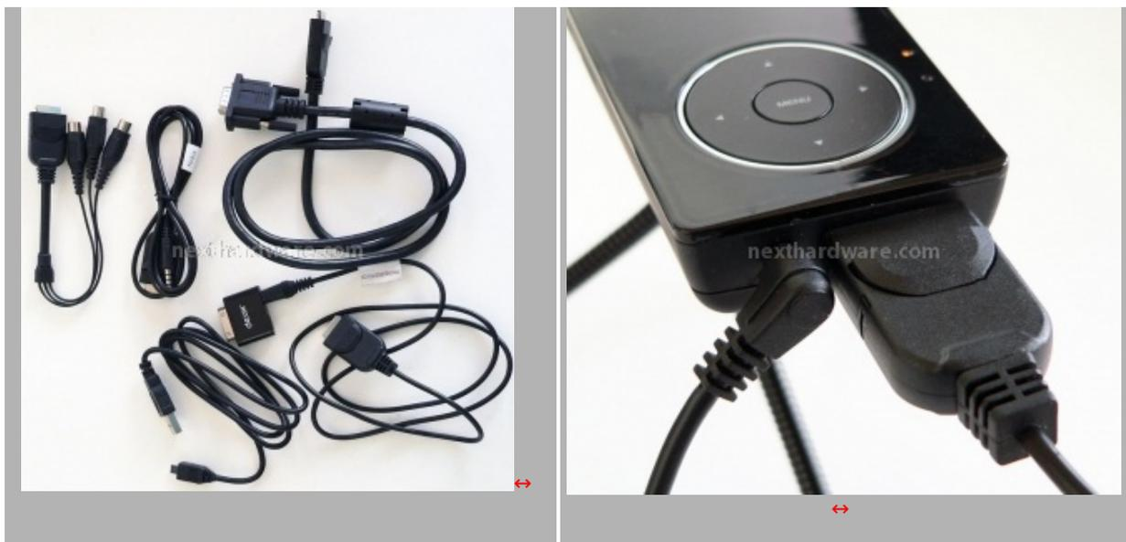
Tutte le interfacce si collegano ad un'unica porta di comunicazione universale, posta sul retro del proiettore, in prossimità del jack di alimentazione.
