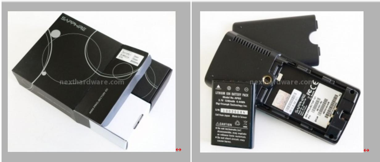
La natura mobile del pico proiettore di Sapphire è confermata dalla presenza di una batteria agli Ioni di Lito da 1200 mAh che dovrebbe garantire un'™autonomia fino a 145 minuti, al massimo della luminosità questo valore si abbassa notevolmente riducendosi di circa 1/3. Un comodo caricabatterie portatile è incluso ed è utilizzabile per alimentare il proiettore quando si è vicino ad una presa elettrica.
