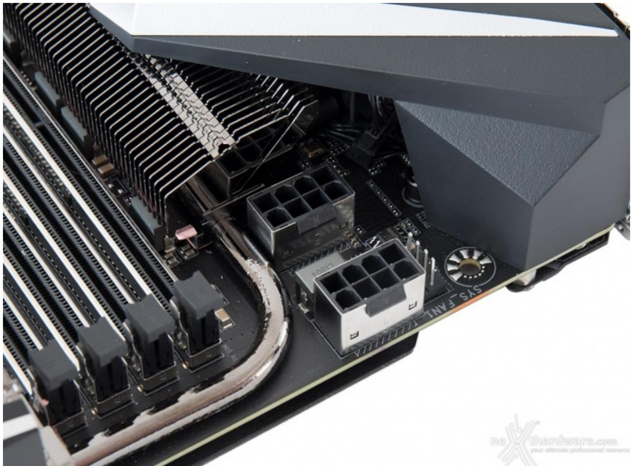
La presenza di un doppio connettore EPS 8 pin garantisce che la sezione di alimentazione riceva tutta la corrente necessaria, in particolar modo nelle condizioni di carico più gravose.
