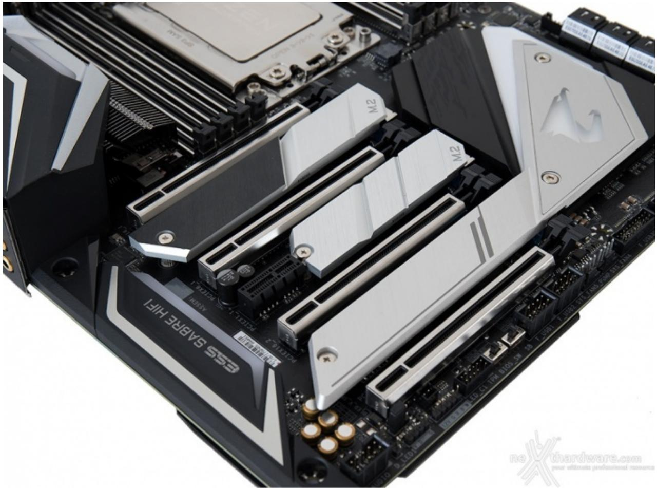
Nella foto in alto sono visibili i cinque slot PCI-E di cui è dotata la XTREME, ovvero quattro a lunghezza intera (di tipo 3.0) direttamente collegati alla CPU ed uno a lunghezza ridotta (di tipo 2.0) pilotato dal chipset X399.
