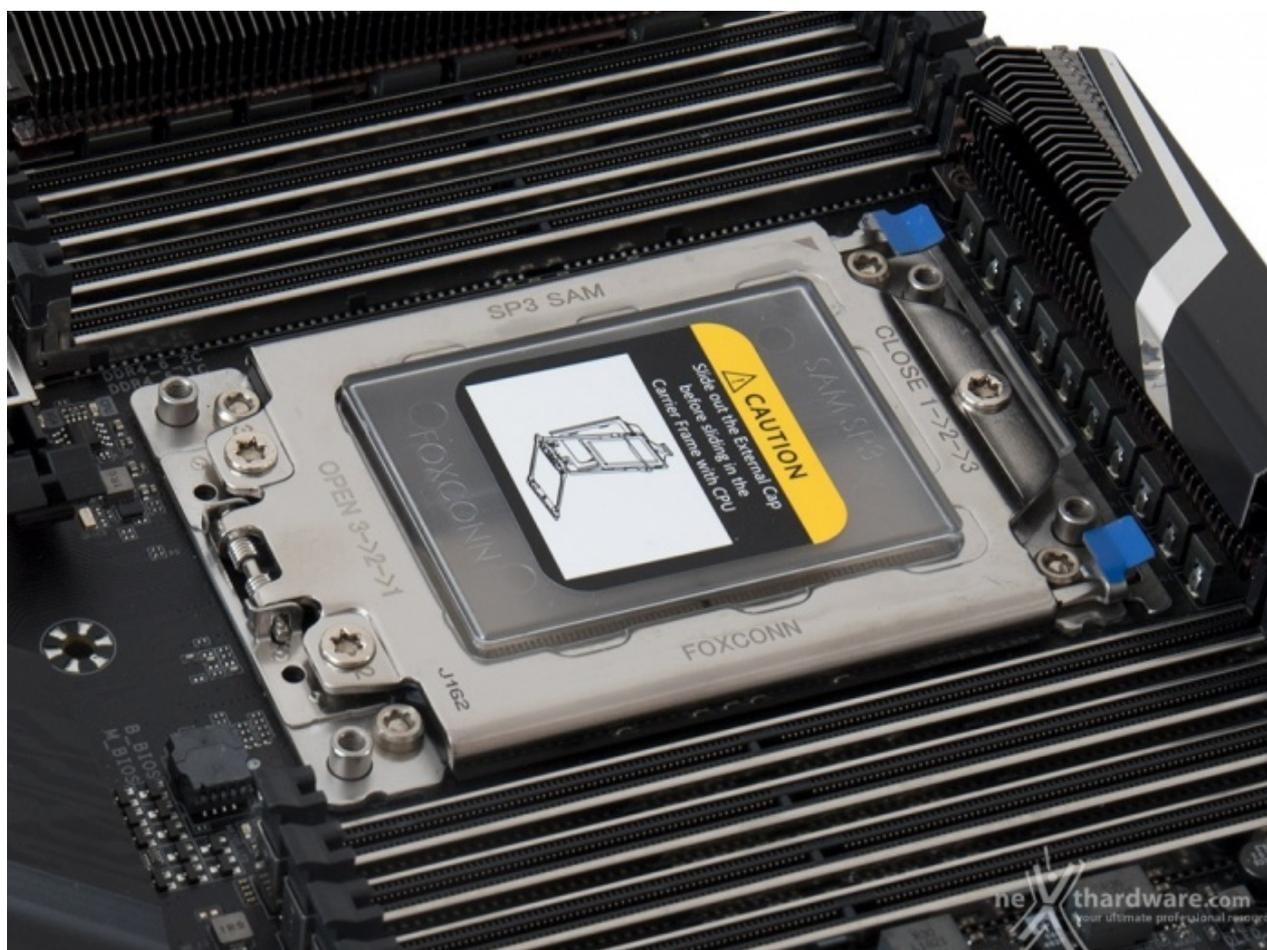
La GIGABYTE X399 AORUS XTREME è stata equipaggiata con un socket TR4 realizzato da Foxconn compatibile con le CPU AMD Threadripper di prima e seconda generazione.
