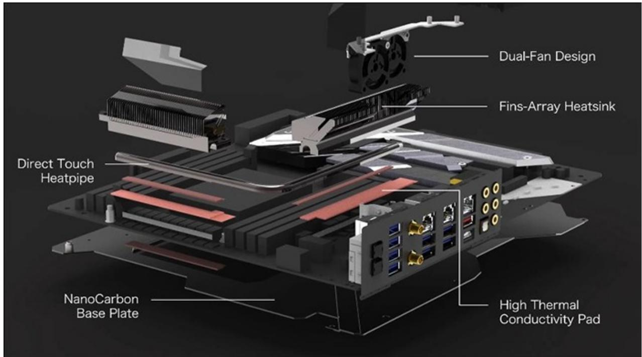
L'immagine soprastante ci mostra nel dettaglio uno schema di tutta la componentistica utilizzata per il sofisticato sistema di dissipazione della GIGABYTE X399 AORUS XTREME.
