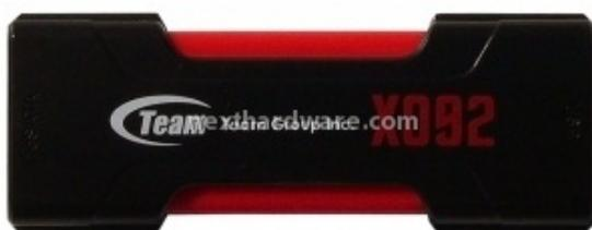
Entrambe le connessioni sono protette dall'involucro plastico della penna e può essere usata una sola interfaccia di comunicazione per volta. Sotto la cover rossa è presente un led dello stesso colore, che si illumina quando si effettua un qualche tipo di accesso alla memoria. La qualità dei materiali è soddisfacente, anche se la slitta ha un po' di gioco a fine corsa.
