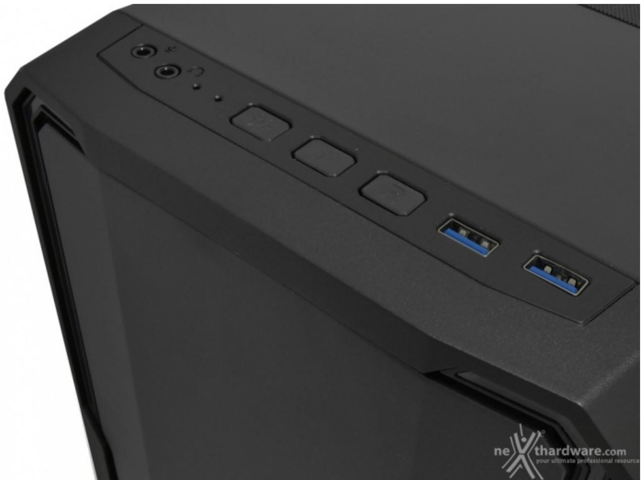
Nella zona anteriore alta del case è posizionato il pannello di I/O comprendente due porte USB 3.1, i pulsanti di accensione e reset, quello per il controllo del sistema di illuminazione integrato, i due LED di stato e due Jack HD Audio per cuffie e microfono.
