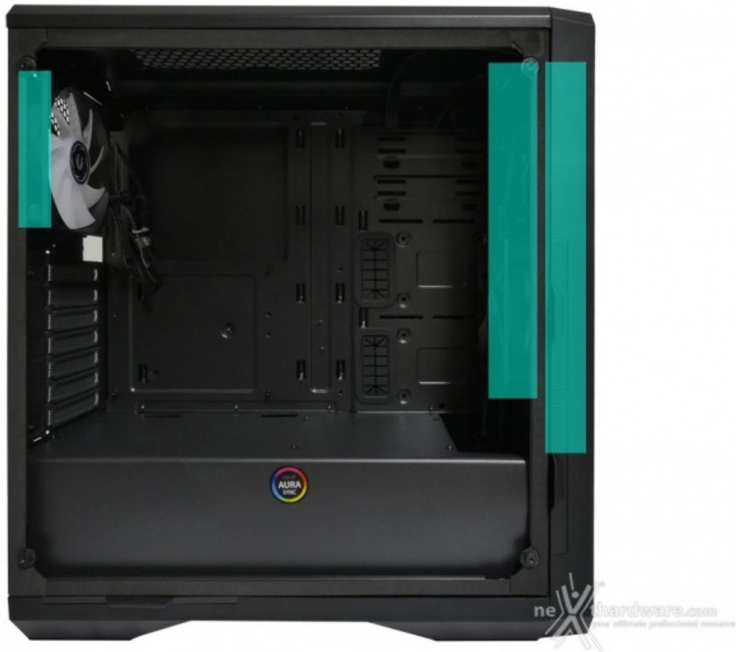
Sia la predisposizione posteriore che quella anteriore potranno essere utilizzate per il contenimento di radiatori facenti parte di sistemi di raffreddamento a liquido custom o AiO, nello specifico uno da 120mm sul retro e uno da 240 o 280mm, con spessore massimo di 35mm e larghezza di 141mm, frontalmente.
