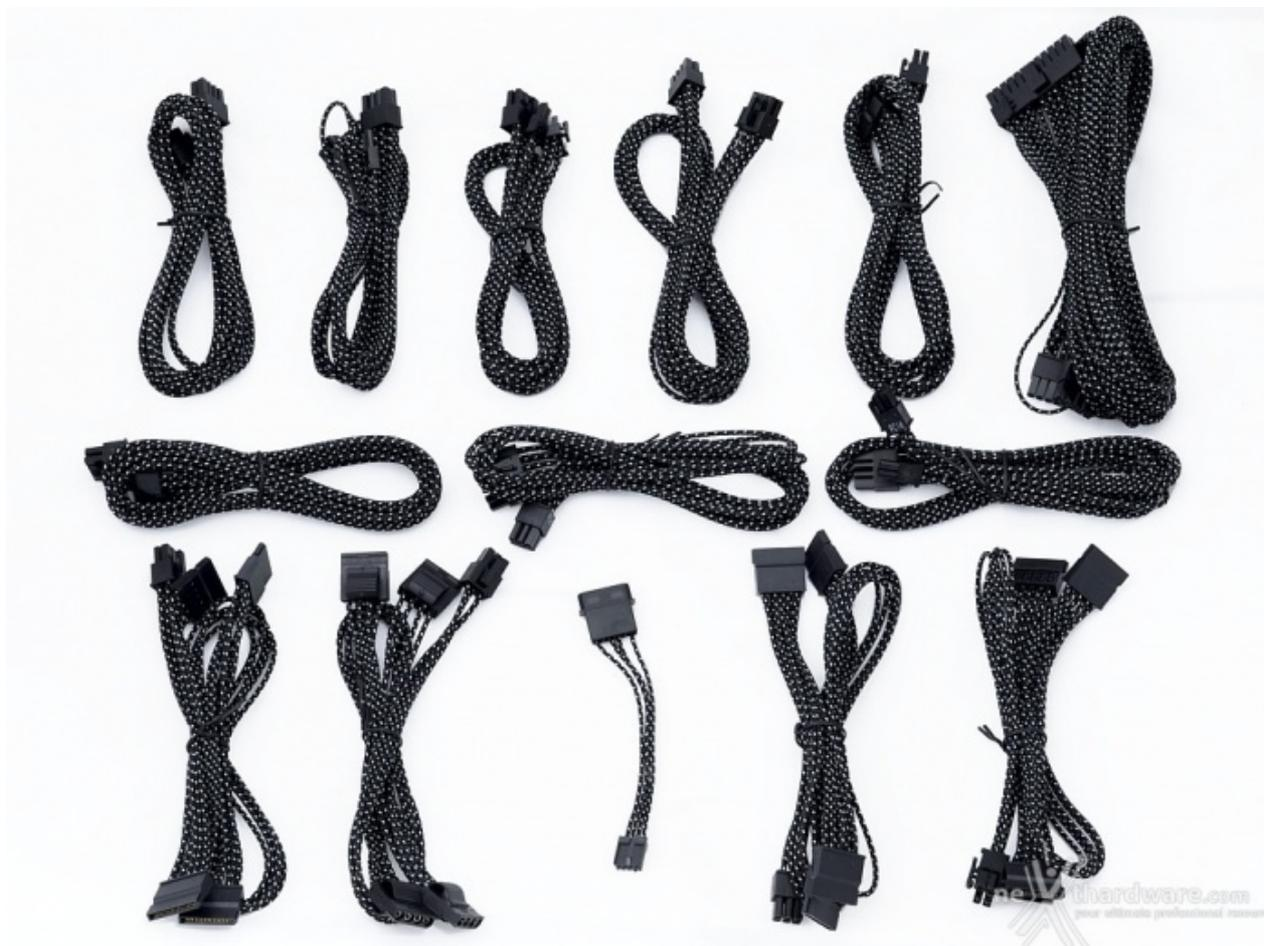
Il cablaggio fornito da ENERMAX a corredo del suo MaxTytan 800W è senza dubbio adeguato alla potenza disponibile; troviamo, infatti, oltre al cavo ATX ed ai due EPS, ben sei connettori PCI-E e sedici connettori tra SATA e molex.
