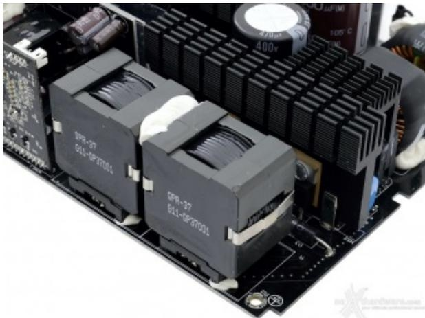
Particolare del dissipatore dedicato ai componenti del sistema di controllo del fattore di potenza e dei due induttori associati.
