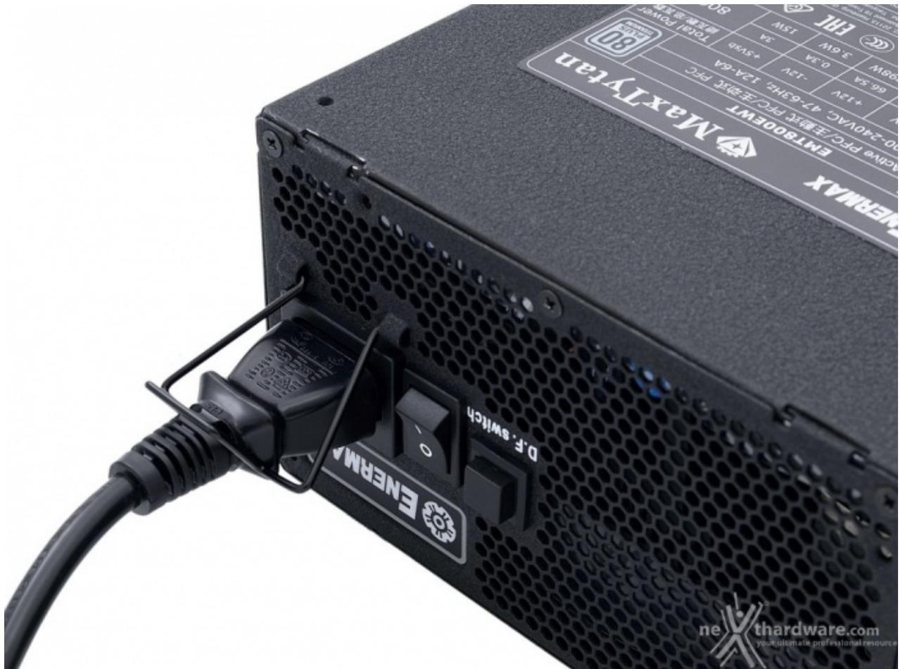
Il sistema CordGuard, introdotto sul finire del 2009, è un meccanismo estremamente semplice ed altrettanto efficace per prevenire la rimozione accidentale del cavo di alimentazione.
