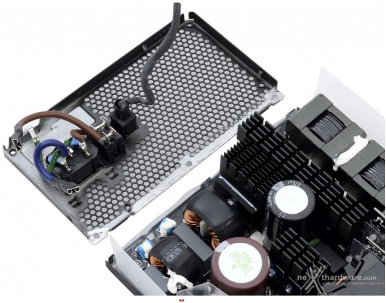
Lo chassis utilizzato da ENERMAX per il MaxTytan 800W è costituito da tre parti avvitate tra loro; la griglia posteriore è quindi removibile e mostra la presa di alimentazione con due condensatori appartenenti al filtro d'ingresso e l'interruttore a due vie utilizzato, però, su un solo cavo.
