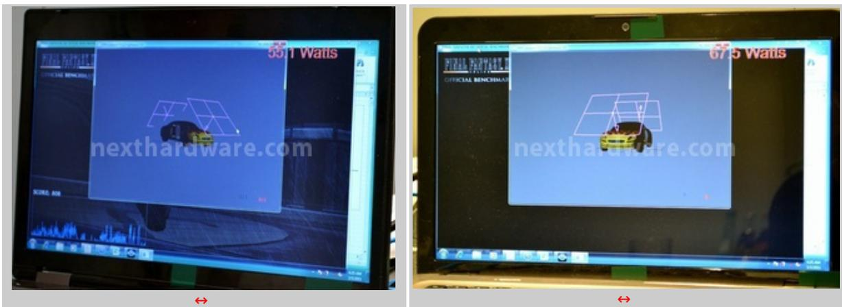
Durante la prova, la macchina dotata di CPU Sandy Bridge non è riuscita ad operare in modo fluido a causa della ridotta potenza della GPU integrata Intel HD Graphics HD 3000; nessun problema, invece, per la soluzione APU Llano, grazie proprio alla qualità del core grafico utilizzato.
