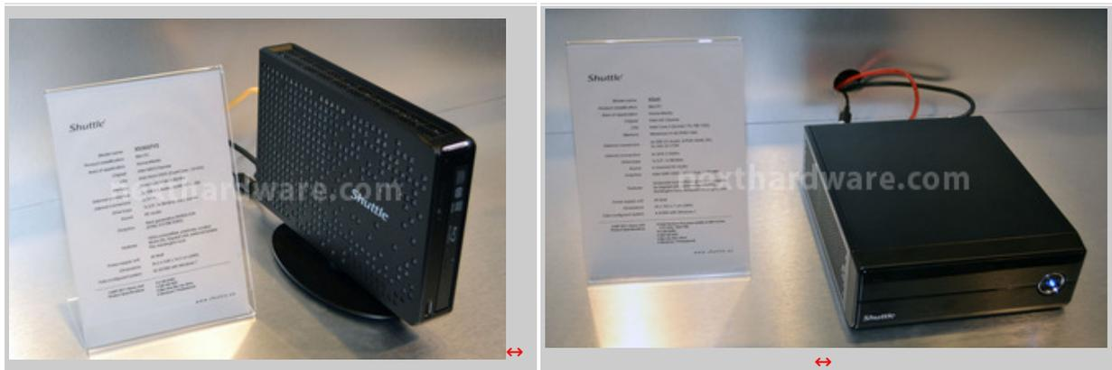
L'XG41 è un Mini PC basato sulla piattaforma Intel 775, non certo una soluzione all'ultimo grido ma, date le ridotte dimensioni, può diventare una buona soluzione per riutilizzare un vecchio processore.
