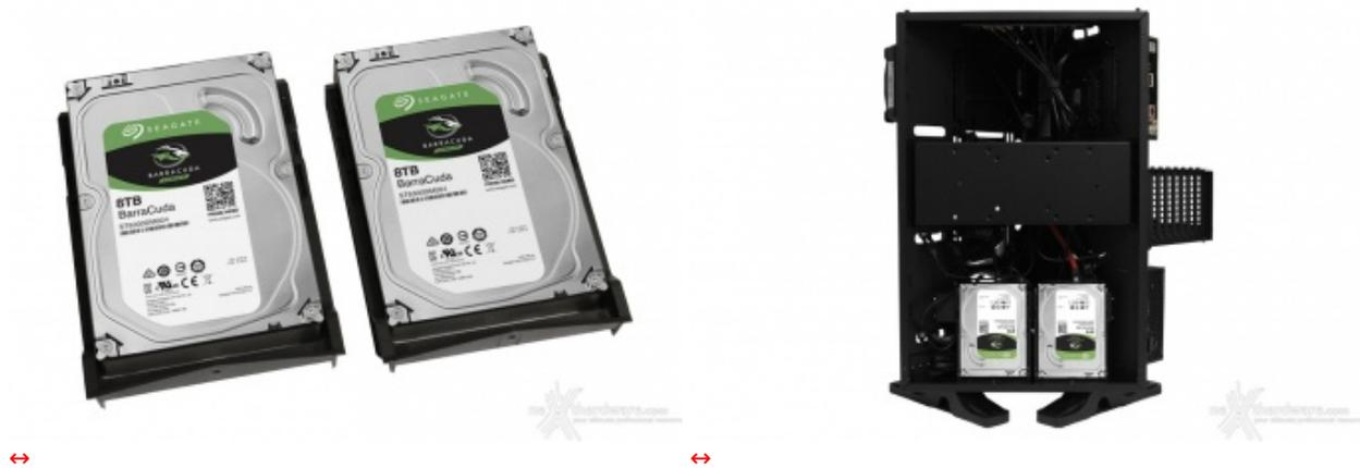
Come abbiamo accennato in precedenza, i drive da 3,5", esteticamente poco gradevoli, sono stati posizionati all'interno della struttura principale usufruendo delle due slitte in dotazione.
