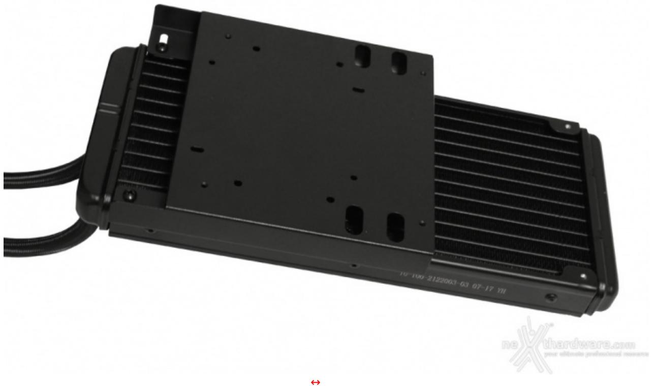
L'unica soluzione possibile, per questo e probabilmente per molti altri AiO, consiste nell'utilizzare un supporto per Hard Disk in dotazione, così da installare il radiatore orizzontalmente.
