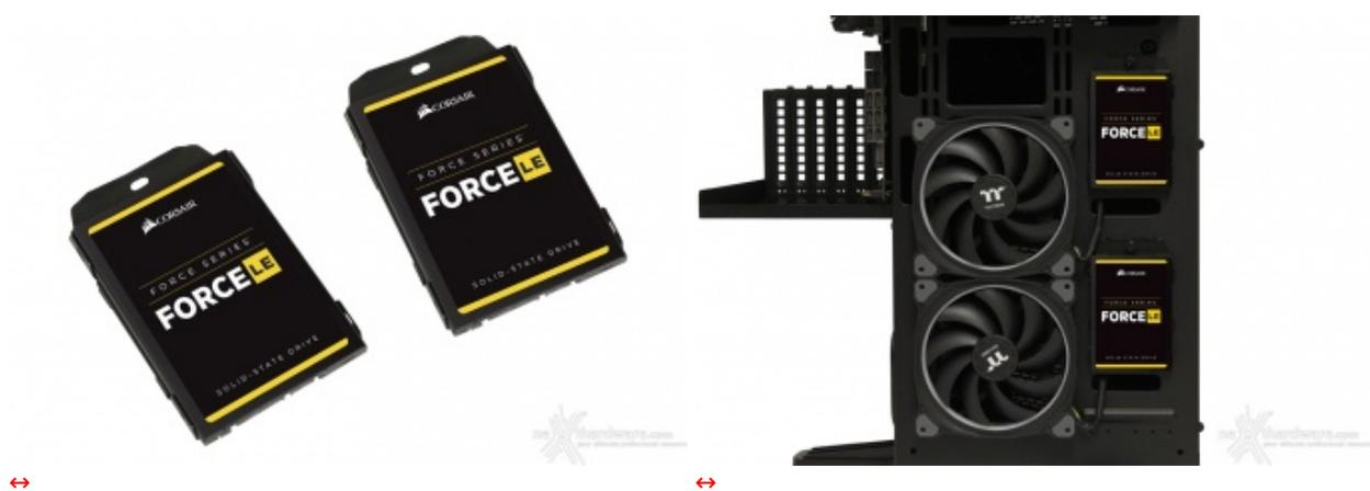
Per quanto riguarda i due SSD, invece, abbiamo scelto di fissarli, tramite appositi supporti, di fianco alle due ventole da 140mm.
