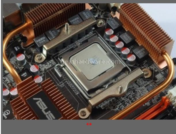
2. Giriamo quindi la scheda madre tenendo fermo il backplate e provvediamo a serrare i due "ponti" che fungeranno da appoggio e sistema di serraggio per il dissipatore. Ricordate di dotare gli "occhielli" delle apposite rondelle adesive isolanti. Poca pasta termica, e siamo pronti per la fase successiva.
